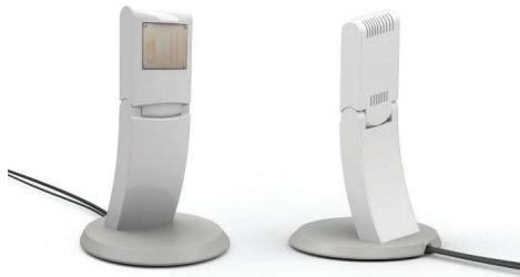
図2 79 GHz 帯レーダによる非接触見守りセンサ VitaWatcher
