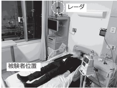
図1 呼吸器内科の病室内に設置されたレーダ [2]. レーダは斜め上から被験者の使用するベッドを見下ろす角度で設置されている. この写真中の人物は実際の被験者ではない.
