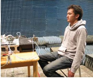
図 5 非接触心拍計測のためのレーダ測定風景 [12]。
