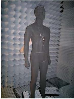
図1 レーダイメージング実験に用いた人体模型 [3]。
