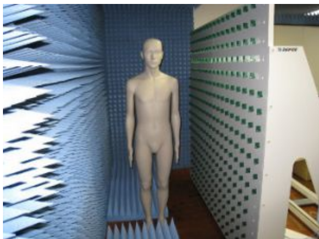
模擬人体を用いたレーダ測定風景
