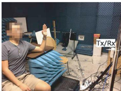
図 13 ジェスチャー自動識別技術を実証するための 2.4 GHz ドップラーレーダ実験風景 [40]
