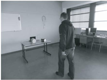
図 5 歩行中の人体のドップラレーダ測定実験 [22]
